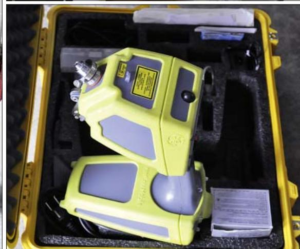
**Mess-Ausrüstung:** Auf dem GW-Mess der BF Tarnów wird u. a. ein StreetlabMobil mitgeführt. Mit der Raman Spektroskopie können chemische Substanzen (Pulver, Feststoffe, Flüssigkeiten) identifiziert werden.
