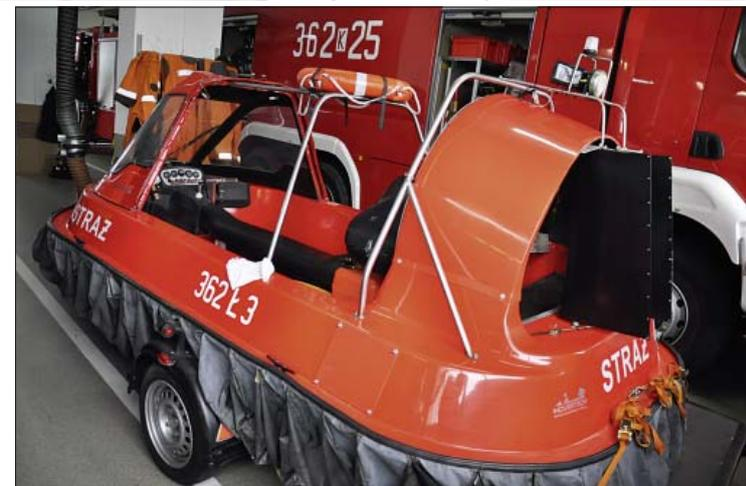
**USAR-Einheit Tarnów:** Zur Ausrüstung der auf Technische Hilfeleistungen und Hochwassereinsätze spezialisierten Feuerwehrkräfte der Einheit gehört neben einem Hovercraft, der vor allem zur Menschenrettung bei Eisunfällen zum Einsatz kommt, auch ein Einsatz-Quad.
