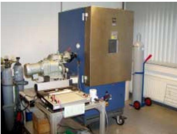
Bild 1: Prüfung auf Temperaturbeständigkeit in eine Temperaturschrank
