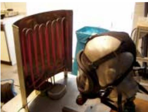
Bild 2: Prüfung einer Vollmaske auf Beständigkeit gegen Wärmestrahlung
