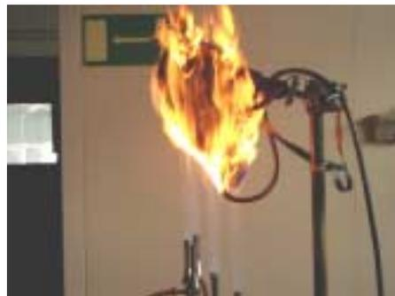
Bild 4: Prüfung eines Lungenautomaten auf Entflammung
