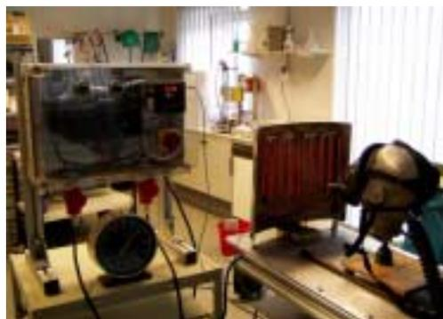
Bild 3: Prüfung eines Lungenautomaten auf Beständigkeit gegen Wärmestrahlung
