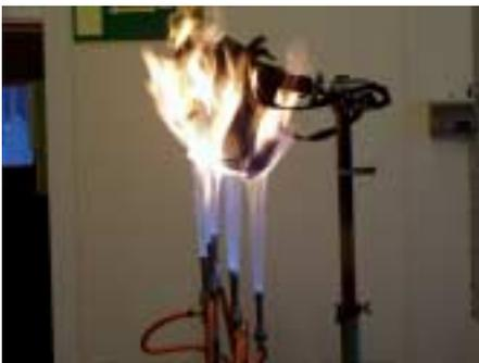
Bild 3: Prüfung einer Vollmaske auf Entflammung
